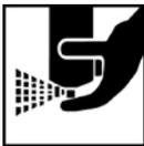
Um die Düse zu reinigen, den Behälter auf den Kopf stellen und das Aerosol kurz betätigen. Das Treibgas drückt die Rückstände aus der Düse und verhindert so deren Austrocknen, wodurch das Aerosol wiederverwendet werden kann.
