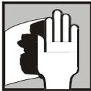
Vor dem Sprühen die zu schützende Oberfläche von Staub befreien und, soweit möglich, mit dem Reiniger APP W900 oder APP BENZ entfetten.
