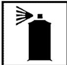
Vor dem Sprühen die zu beschichtende Oberfläche schleifen, von Staub befreien und entfetten. Einen Probesprühtest durchführen.
